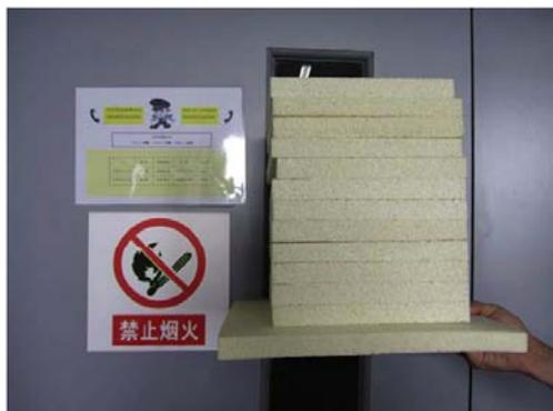
图 2. 中科院宁波材料所成型制备的聚酰亚胺微发泡板
